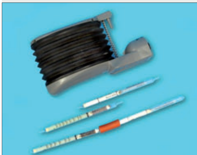
Figura 2. Analizador portátil de gases (monóxido de carbono, etc.).
